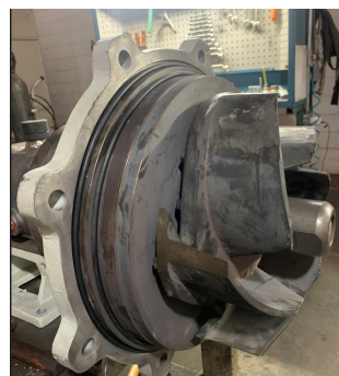
Figura 16 – Caracterização de uma bomba de rotor aberto e seus fundidos em liga de Ni-hard ASTM A 532.
