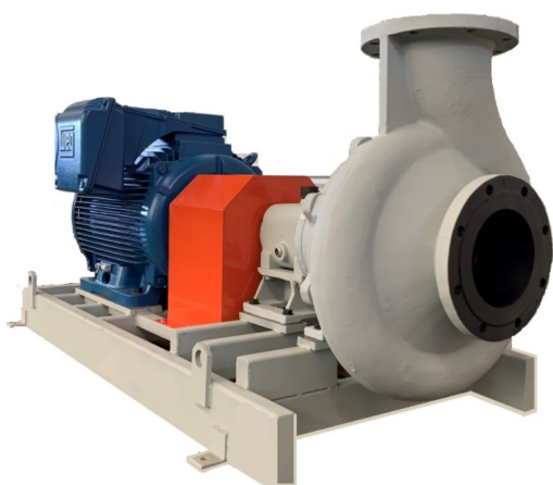
Figura 16 – Caracterização de uma bomba de rotor aberto e seus fundidos em liga de Ni-hard ASTM A 532.
