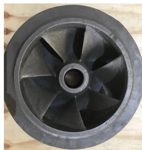
Figura 16 – Caracterização de uma bomba de rotor fechado e seu rotor fundido em liga de Ni-hard ASTM A 532.
