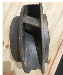
Figura 16 – Caracterização de uma bomba de rotor fechado e seu rotor fundido em liga de Ni-hard ASTM A 532.
